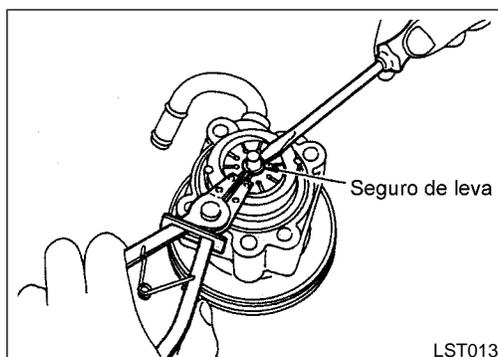
8. Expanda el seguro con pinzas y remuévalo de la ranura del eje impulsor con un destornillador.
