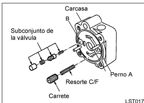
10. Remueva el seguro de la leva, el rotor, los álabes y la placa lateral delantera, quite el carrete, el resorte de control de flujo y el conjunto de la válvula de control de flujo de las ranuras A y B.
